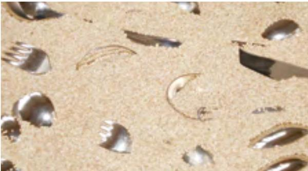
Dort durchläuft es über einen spiralförmigen Aufstieg ein hochwertiges warmes Poliergranulat.
